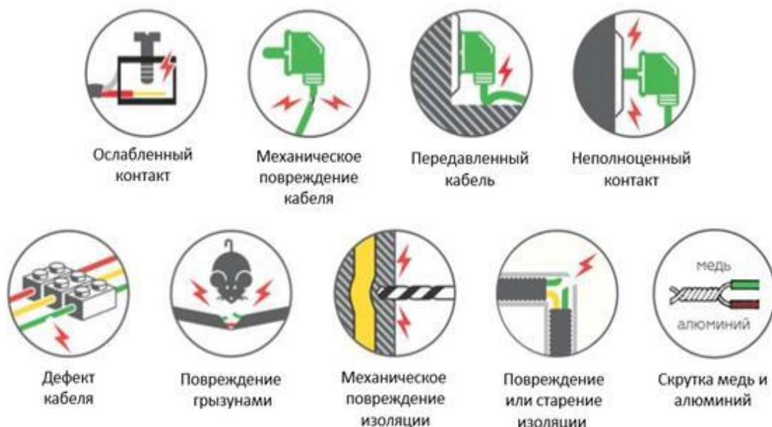
Рисунок 6. Возможные причины искрения в электропроводке
